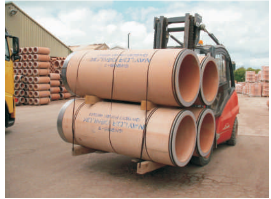
ROHRE WERDEN FÜR DEN VERSAND VERLADEN
